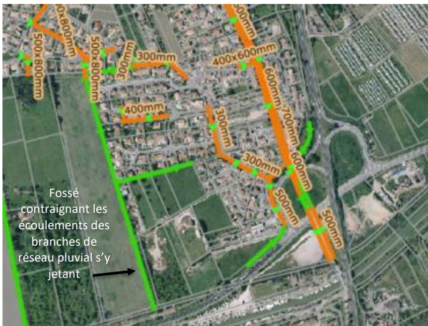
Illustration 37 : Localisation du fossé qui contraint les écoulements du secteur
