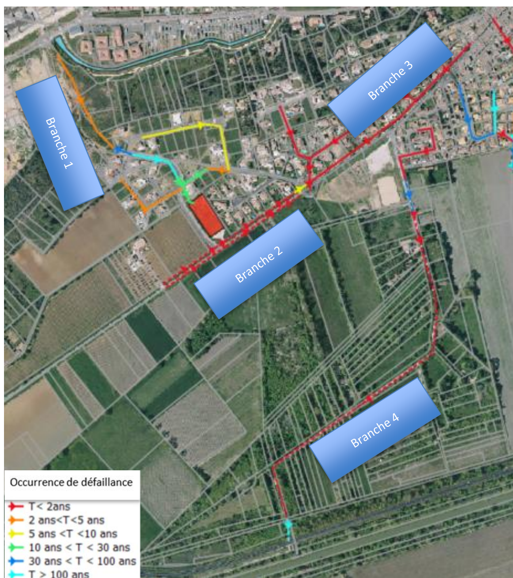
Illustration 42 : Cartographie des occurrences de défaillances du réseau pluvial du secteur Sud-Ouest
