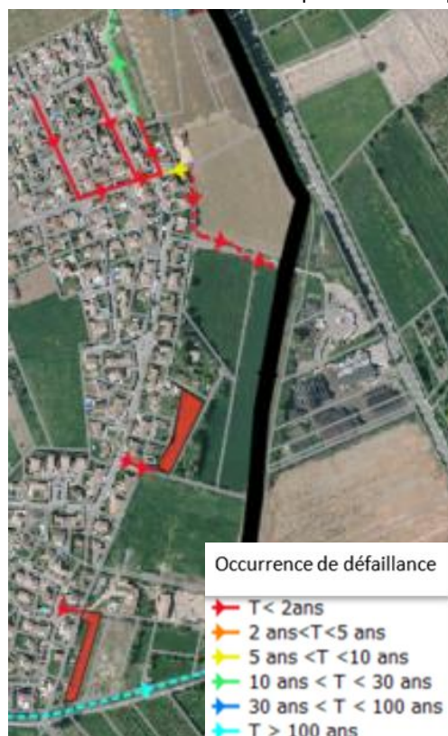
Illustration 41 : Cartographie des occurrences de défaillances du réseau pluvial du secteur Sud-Est
