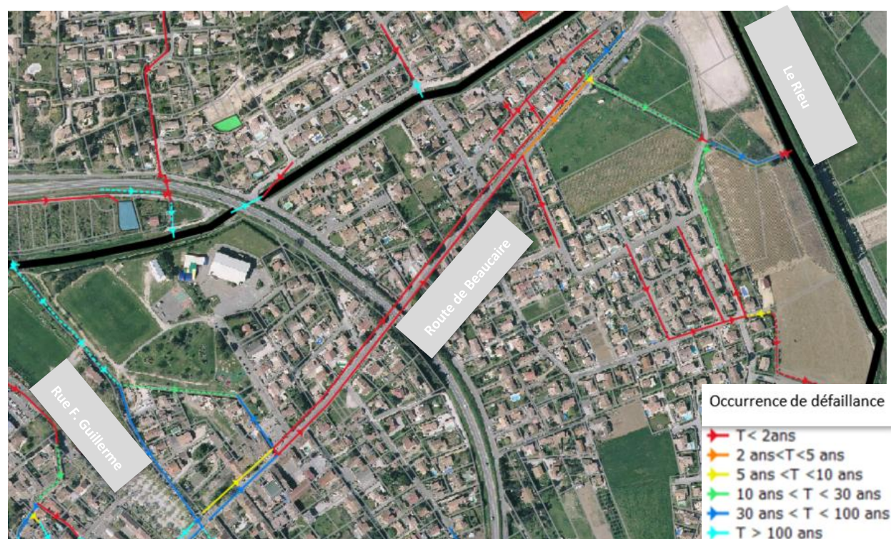
Illustration 40 : Cartographie des occurrences de défaillances des réseaux pluviaux du secteur Est
