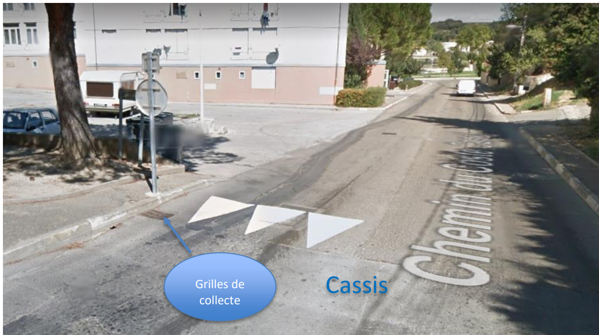
Illustration 20 : Dispositif servant à diriger le ruissellement vers le réseau pluvial (Chemin du Cros des Bards), source Google maps
