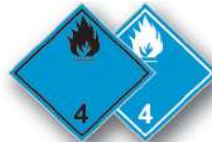
N°4.3 Danger d'émission de gaz inflammable au contact de l'eau
