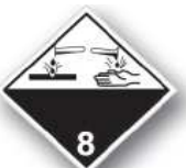
N°8 Matière corrosive
